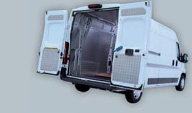
1 Avec l'aide d'une commande à distance, le hayon élévateur "VH Easyloader" peut être amené en position, ce qui permet de placer la charge sur le hayon élévateur. Celle-ci est alors à plat sur le sol. La plateforme de chargement a une épaisseur de 5 mm à l'avant, celle-ci va jusqu'à de 18 mm.
