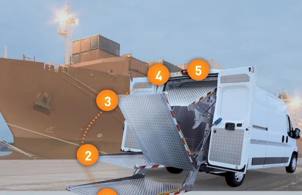
1 Met behulp van een afstandsbediening kan de "VH Easyloader" laadklep in de positie gebracht worden, waarin de lading op de laadklep gezet kan worden. De laadklep ligt dan plat op de grond. Het laadplatform is vooraan 5 mm dik, dit loopt op naar 18 mm.
